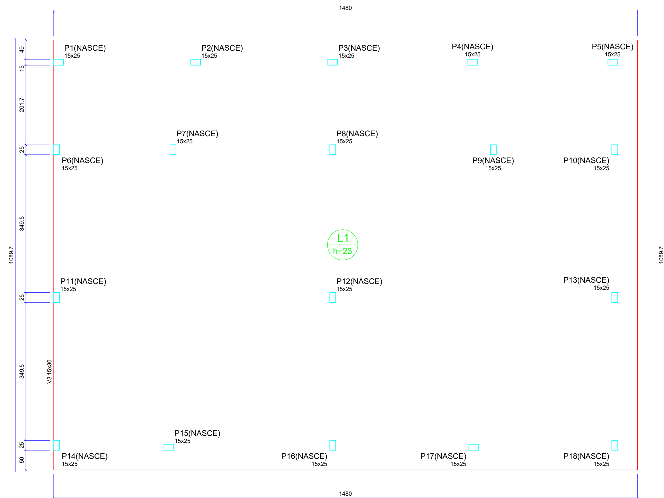
FORMA DO PAVIMENTO PAVIMENTO Escala 1:50
